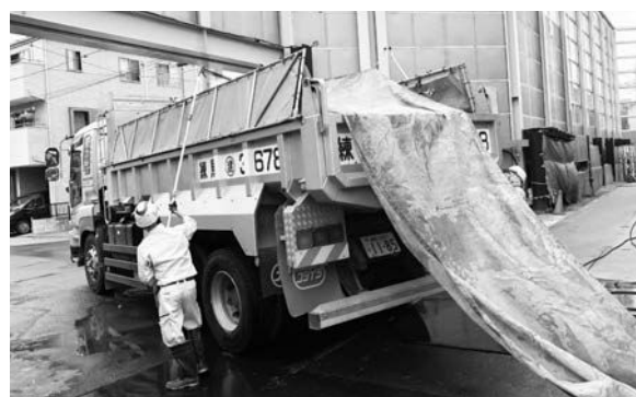
写真-17 荷台シート掛け作業
